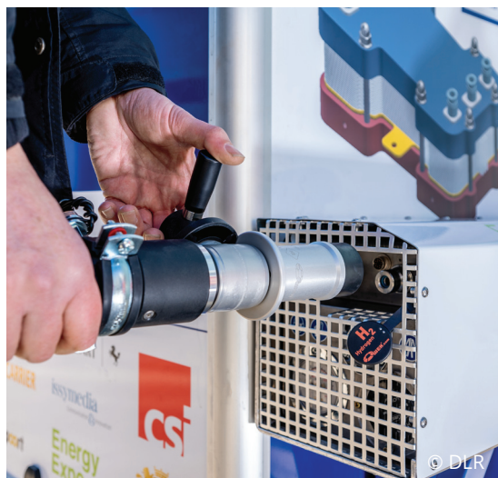
Wasserstoff-Betankungsvorgang am FCCP
