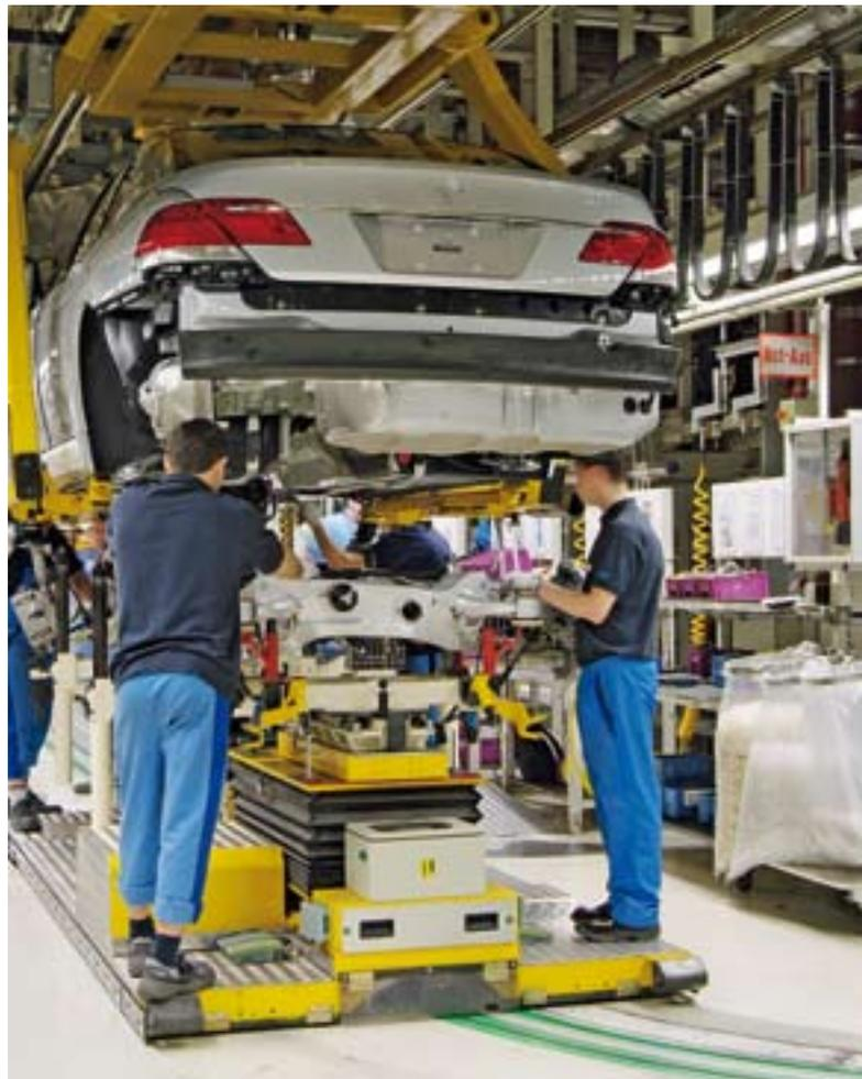
Wo früher Nieten, Schrauben oder Schweißnähte für stabile Verbindungen sorgten, werden in der Automobilfertigung heute oft industrielle Klebstoffe eingesetzt.
