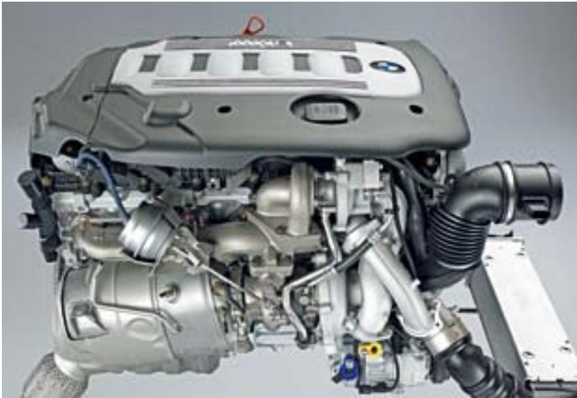
Sieger 2007: Sechs-Zylinder-Diesel-Motor von BMW mit variabler Twin-Turbo-Technologie.
