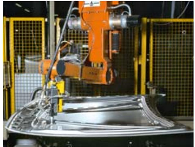
Kleberoboter ersetzen im Autobau immer häufiger Schweißroboter.
